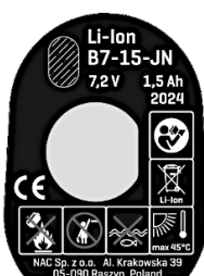
Tabliczka znamionowa akumulatora
